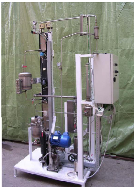
Слика 2.6. Прототип једностепене амонијачне апсорпционе топлотне пумпе BioAWP [11]
