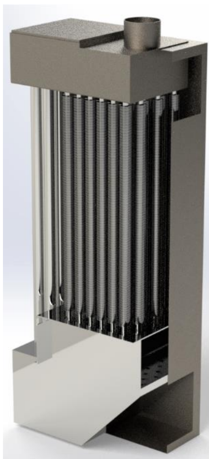
Слика 4.5. 3D изглед геометрије ГВВ са не оребреним цевастим измењивачима топлоте (лево) и оребреним (десно)
