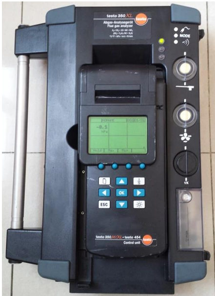
Слика 3.38. TESTO 350 XL и 454 за аквизицију протока продуката сагоревања и концентрације CO
