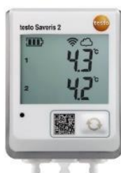
Слика 3.30. Testo Saveris 2 коришћен за аквизицију температура са спољних површина ГВВ и околних зидова, преграда
