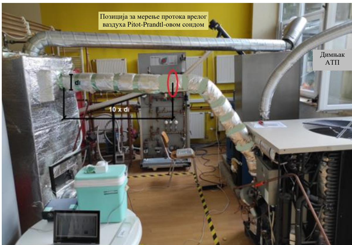
Слика 3.34. Позиција мерења протока врелог ваздуха Pitot – Prandtl-овом сондом на растојању од 10 \cdot d_i , ( d_i – унутрашњи пречник цеви врелог ваздуха, 127 mm)
