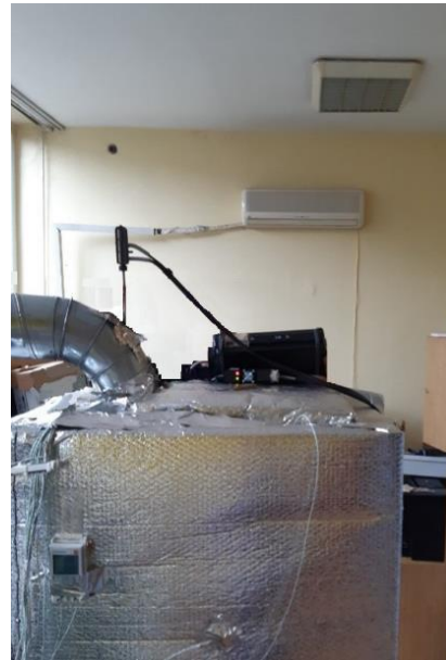
Слика 3.39. Позиција мерења температуре и квалитета сагоревања гасним анализатором TESTO 350 XL и 454 ( d_i – унутрашњи пречник цеви врелог ваздуха, 160 mm)
