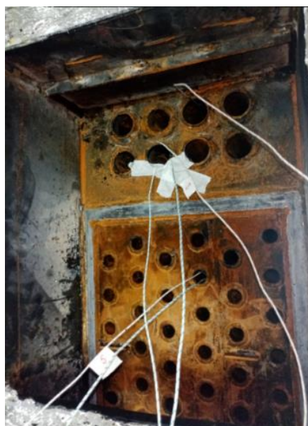
Слика 3.26. Термопарови постављени унутар генератора врелог ваздуха
