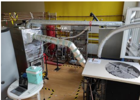
Слика 3.40. Мерна позиција за проток продуката сагоревања (црвено) помоћу Pitot – Prandtl сонде са аквизиционим уређајем TESTO 400, d_i – унутрашњи пречник цеви продуката сагоревања 160 mm
