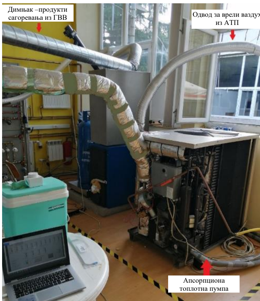
Слика 3.4. Веза генератора врелог ваздуха и АТП помоћу цеви \Phi_i=127 [mm] за погон десорбера АТП са аквизиционом опремом LabView и NI
