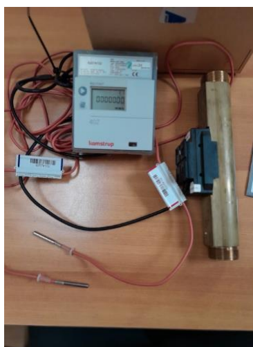
Слика 3.44. Калориметар Kamstrup са мерном блендом за мерење протока и PT – 500 сонде
