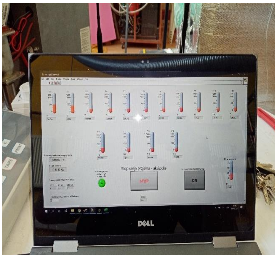
Слика 3.54. Аквизиција температура у програму LabView путем NI
