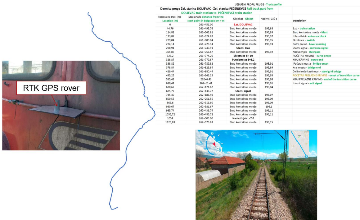
Слика 8.6 Дигитализација трасе на којој ће се вршити тестирање [92]
