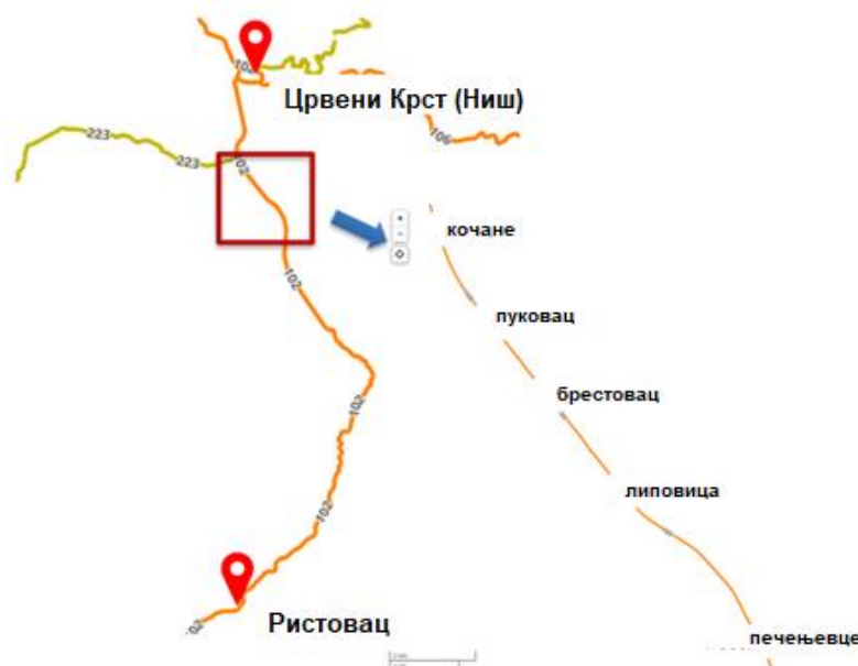
Слика 8.5 Приказ пруге Црвени Крст – Ниш и дела трасе на којој је извршено тестирање уређаја за детекцију препрека [92]
