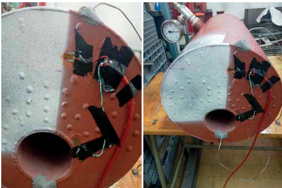
Slika 5.24 - Lokacije mernih traka i označena polja za snimanje sistemom Aramis za beskontaktno merenje pomerjenja i deformacije
