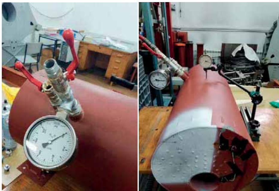
Slika 5.30 - Instalacija manometra, nepovratnog ventila na ulaznom otvoru modela
