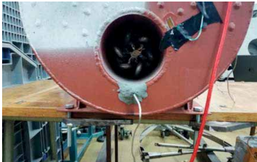
Slika 5.28 - Fiksiranje oslonaca modela za postolje
