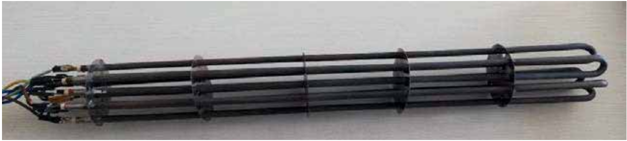
Slika 5.47 - Grejač koji se koristio za potrebe eksperimenta
