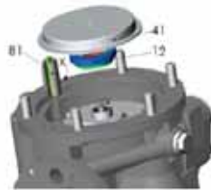
Slika 77 – Rasporedni slog gdje se nalazi klackalica i zabravnik (pozicija 81)
