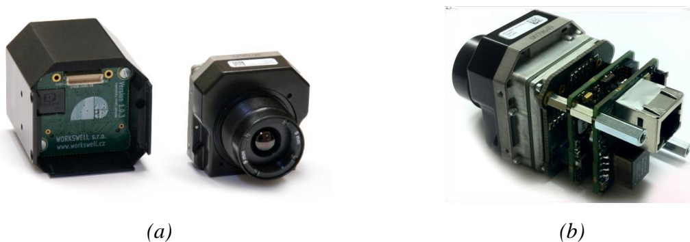
Slika 3.21 Termovizijska kamera i Workswell GigE adapter (a), povezivanje termovizijske kamere i adaptera (b) [216]
