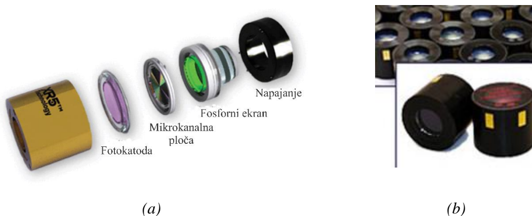
Slika 2.30 Komponente pojačavača slike (a) [203], Pojačavač slike treće generacije HD-1520 kompanije HARDER.digital GmbH (b) [204]
