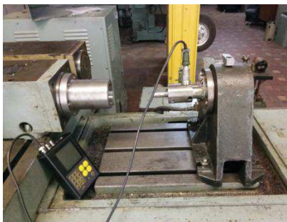
Рис.1. Фото та схема експериментального стенду для дослідження коливань необертюваними борштангами: 1 - тахометр; 2 - шпиндельна головка; 3 - перетворювач частоти; 4 - заготовка; 5 - борштанга; 6 - пристосування; 7 - п'єзодатчик; 8 - аналізатор спектру вібрацій; 9 – різець №1; 10 – різець №2.
