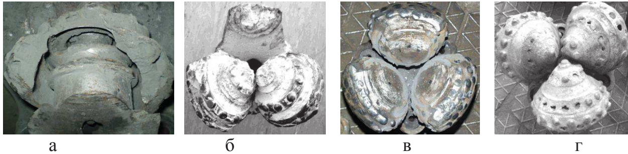
а – розколювання тіла шарошки, б – відламування цапфи лапи, в – заклинювання опор і зупинення обертання шарошок, г – розколювання, зношування, випадання вставного породоруйнівного оснащення шарошок
