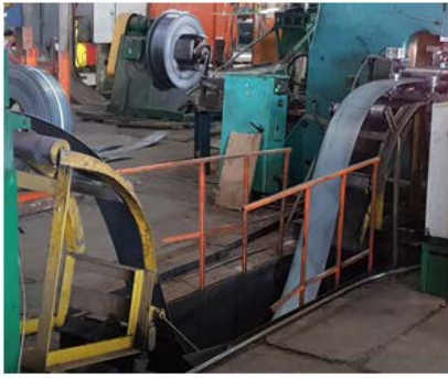
Рис.3. Подавач листового прокату до штамп
