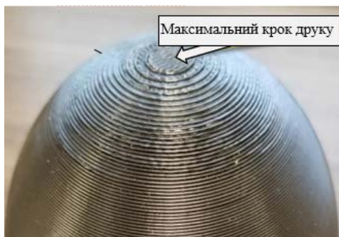
Рис.1. Куля, надрукована з використанням технології FDM [9]
