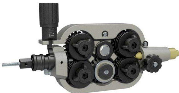
Slika 8.9 Mehanizam za dodavanje elektrodne žice sa dva pogona i dodatnim valjcima za ispravljanje [11]
