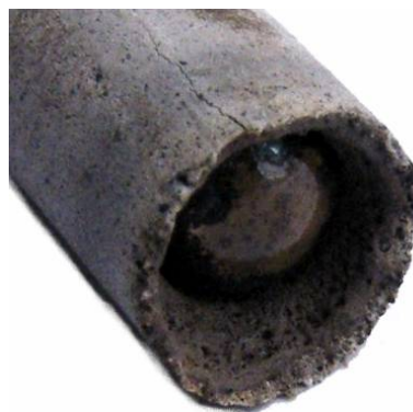
Slika 10.12 Metalno jezgro i obloga elektrode za REL postupak zavarivanja
