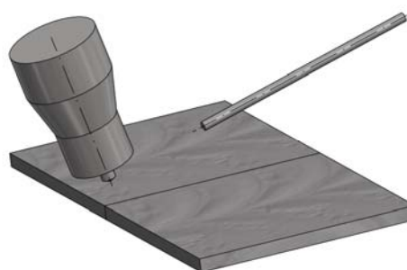
Slika 7.21 Tehnika zavarivanja sučeonih spojeva kod ploča TIG postupkom – primicanje i odmicanje elektrode uz ciklično pomeranje elektrode
