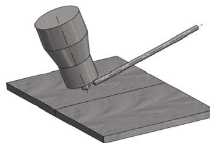
Slika 7.23 Tehnika zavarivanja sučeonih spojeva kod ploča TIG postupkom – primicanje i odmicanje elektrodne žice uz ciklično pomeranje netopive elektrode
