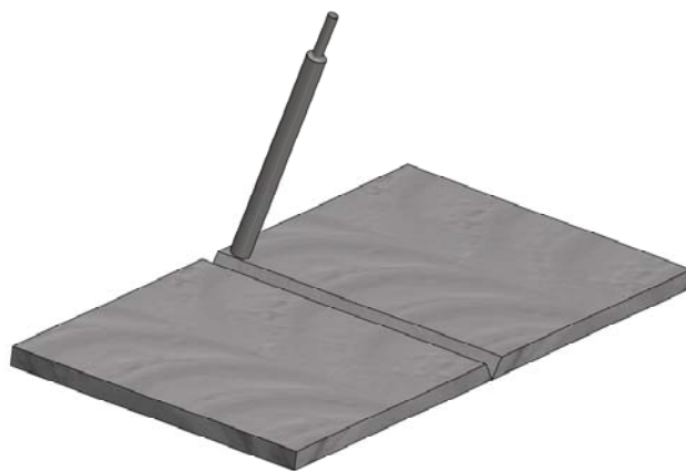
Slika 10.24 Sučeono zavarivanje ploča REL postupkom u horizontalnom položaju – sa leva na desno
