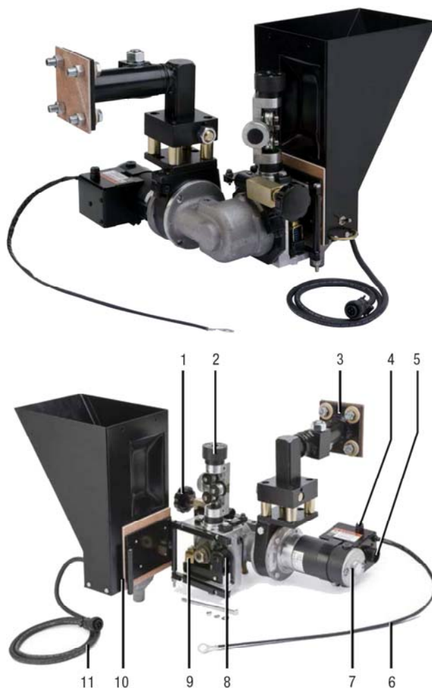
Slika 11.7 Tipičan sistem za dovođenje EPP žice sa bunkerom za prašak: 1) zavrtanj za podešavanje brzine dotura žice, 2) ispravljač elektrodne žice, 3) nosač mehanizma, 4) električni osigurač, 5) električni priključak, 6) naponski kabel, 7) motor, 8) valjak za vođenje, 9) senzor, 10) bunker za prašak, 11) električni priključak ventila za regulisanje dotura praška [9]
