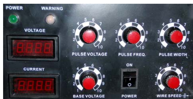
Slika 8.13 Kontrolna tabla tipičnog MIG/MAG izvora struje
