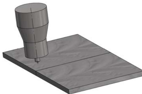
Slika 7.16 Tehnika zavarivanja sučeonih spojeva kod ploča TIG postupkom – početak zavarivanja
