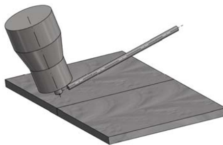
Slika 7.20 Tehnika zavarivanja sučeonih spojeva kod ploča TIG postupkom – nagnjanje elektrode i žice (dodatnog materijala), smer zavarivanja sa leva na desno
