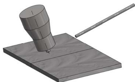
Slika 7.22 Tehnika zavarivanja sučeonih spojeva kod ploča TIG postupkom – primicanje i odmicanje elektrodne žice uz ciklično pomeranje netopive elektrode
