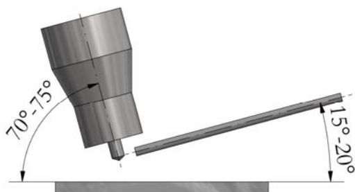
Slika 7.18 Tehnika zavarivanja sučeonih spojeva kod ploča TIG postupkom – nagib elektrode i dodatnog materijala tokom zavarivanja
