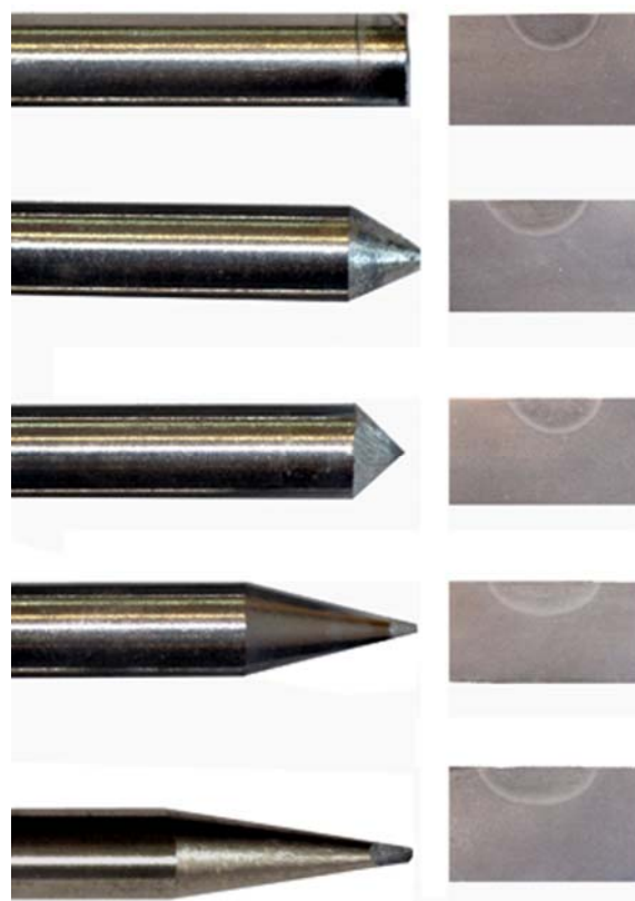
Slika 7.13 Vrh volframove elektrode, oblik i dimenzije traga koji ostavlja električni luk na osnovnom materijalu
