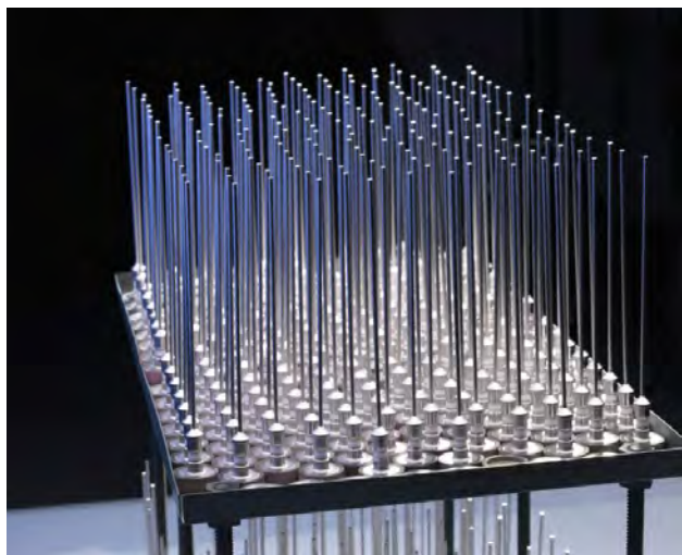
Slika 8.2 Delovi mlaznog motora od titanijuma spojeni postupkom tvrdog lemljenja infracrvenom svetlošću [12]
