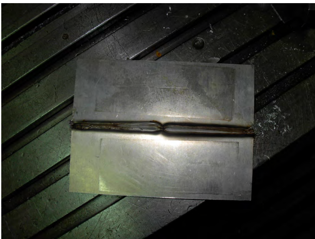
Slika 10.16 Naličje drugog „uspešno” FSW zavarenog šava (foto: Miroslav Mijajlović, Niš, 13.03.2009)
