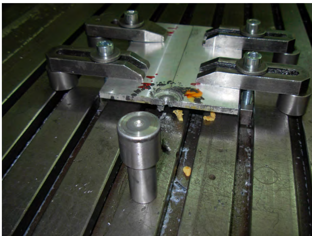
Slika 10.8 Radna mašina, radno mesto, polomljeni alat i pripremci, neuspešan prvi pokušaj (foto: Miroslav Mijajlović, Niš, 13.03.2009)
