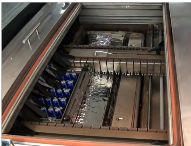
Slika 8.10 Proizvodna linija za postupak niskotemperaturnog talasnog lemljenja [30]
