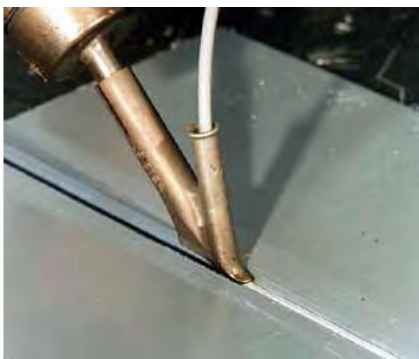
Slika 6.8 Postupak zavarivanja zagrejanim gasom uz primenu profilisane mlaznice [10]
