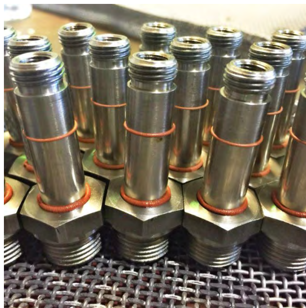
Slika 8.6 Delovi pripremljeni za spajanje postupkom tvrdog lemljenja u peći [22]
