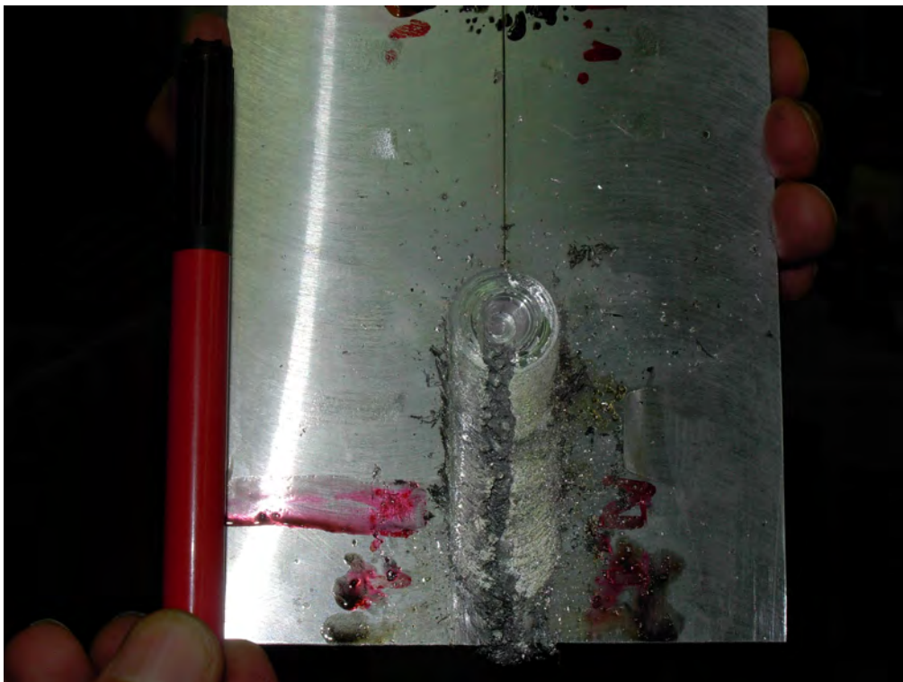
Slika 10.11 Lice prvog „uspešno” FSW zavarjenog šava (foto: Miroslav Mijajlović, Niš, 13.03.2009)
