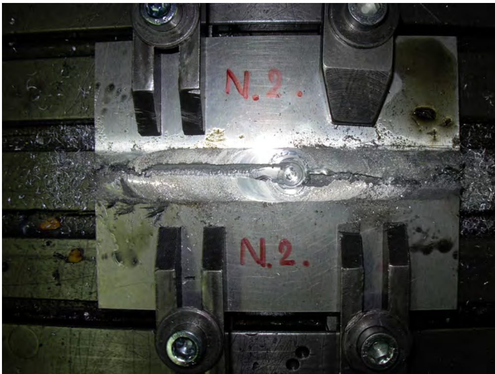
Slika 10.15 Lice drugog „uspešno” FSW zavarenog šava (foto: Miroslav Mijajlović, Niš, 13.03.2009)
