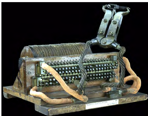
Slika 2.2 Tomsonov uređaj za elektrootporno zavarivanje iz 1886. godine [9]
