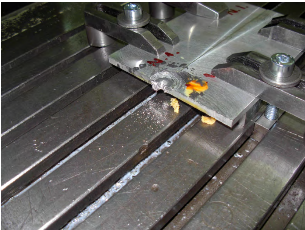
Slika 10.7 Radna mašina, radno mesto, alat i pripremci, neuspešan prvi pokušaj (foto: Miroslav Mijajlović, Niš, 13.03.2009)
