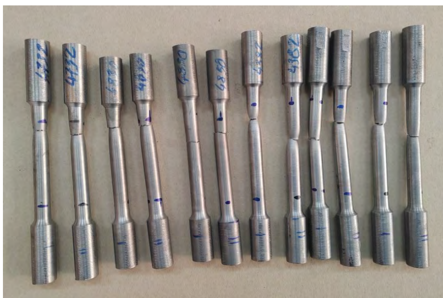
Slika 7.9 Pokidane epruvete ispitivanih čelika
